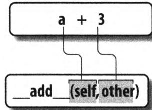
**Рис. 27.3.** При перезагрузке операции выражений и другие встроенные операции, выполняемые над классом, отображаются на методы с особыми именами в классе. Такие специальные методы необязательны и могут быть унаследованы обычным образом. В данном случае выражение `+` запускает метод `__add__`
