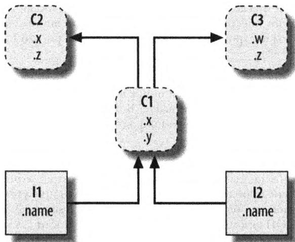
**Рис. 26.1.** Дерево классов с двумя экземплярами в нижней части (I1 и I2), классом выше них (C1) и двумя суперклассами в верхней части (C2 и C3). Все эти объекты являются пространствами имен (пакетами переменных), и поиск в иерархии наследования представляет собой просто обход дерева снизу вверх с целью нахождения самого нижнего вхождения атрибута. Код включает в себе форму таких деревьев
