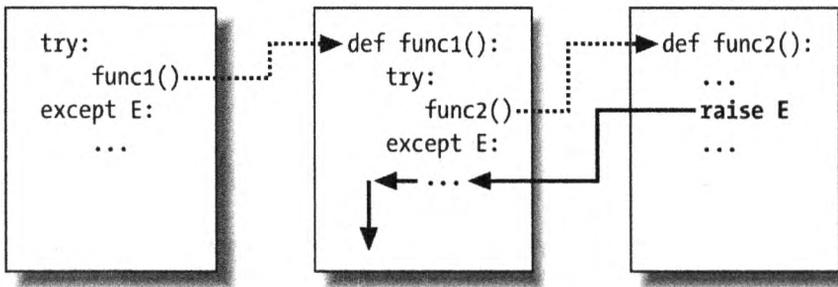
**Рис. 36.1.** Вложенные операторы try/except: когда генерируется исключение (вами либо интерпретатором Python), управление передается самому последнему введенному оператору try с конструкцией except, дающей совпадение, и программа возобновляет выполнение после этого оператора try. Конструкции except перехватывают и прекращают распространение исключения — именно в них производится обработка и восстановление после исключений
