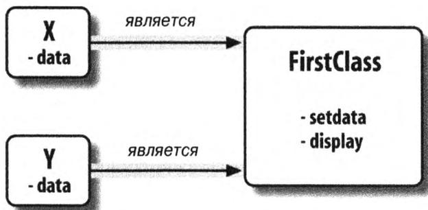
**Рис. 27.1.** Классы и экземпляры связывают объекты пространств имен в дерево классов, в котором ищутся атрибуты при поиске в иерархии наследования. Здесь атрибут *data* находится в экземплярах, но *setdata* и *display* присутствуют в классах, расположенных выше них
