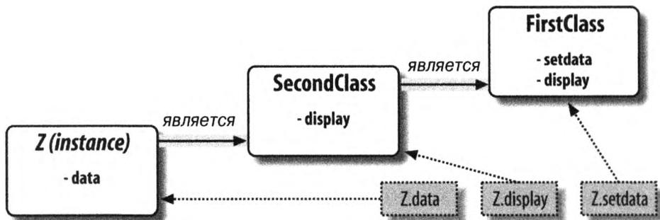
**Рис. 27.2.** Специализация: переопределение унаследованных имен за счет их повторного определения в расширениях ниже в дереве классов. Здесь `SecondClass` переопределяет и тем самым настраивает метод `display` для своих экземпляров
