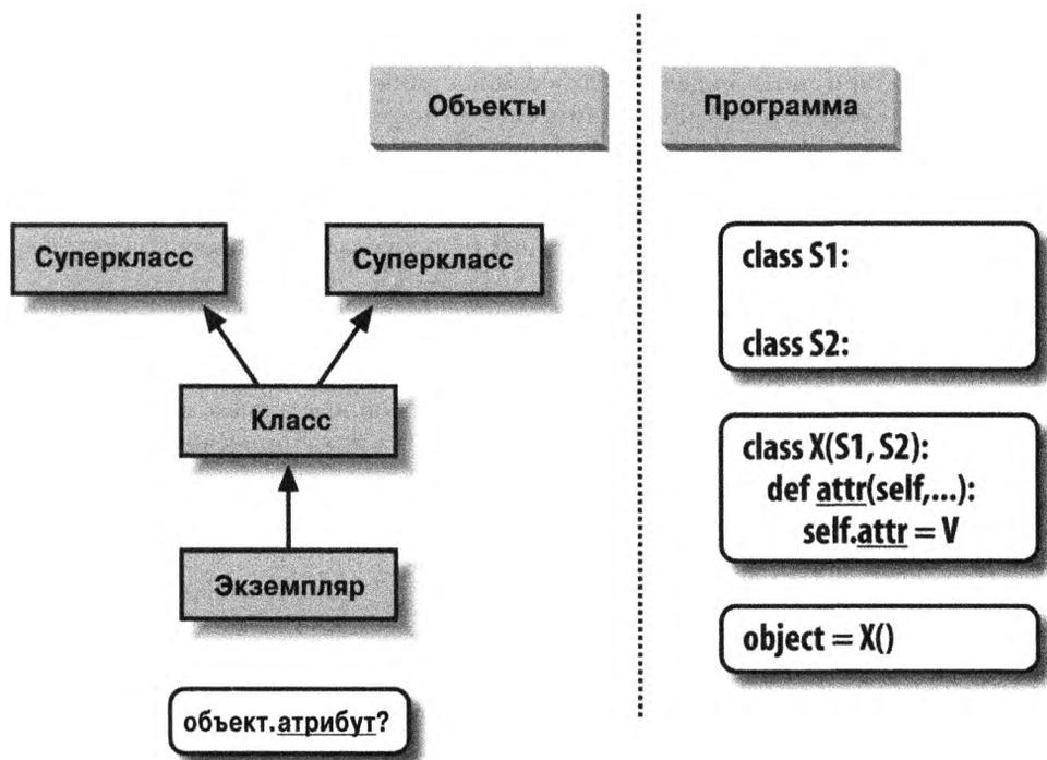
Рис. 29.1. Код программы создает дерево объектов в памяти, где будет происходить поиск со стороны наследования атрибутов. Обращение к классу создает новый экземпляр, который запоминает свой класс, выполнение оператора `class` создает новый класс, а суперклассы перечисляются внутри круглых скобок в заголовке оператора `class`. Каждая ссылка на атрибут запускает новую процедуру восходящего поиска в дереве – даже ссылки на атрибуты `self` внутри методов класса
